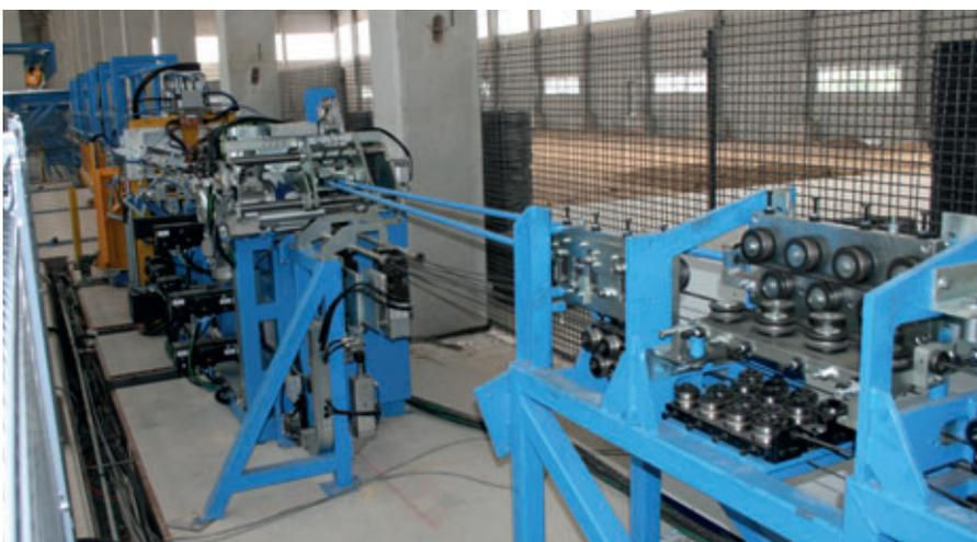
Die Gitterträgerschweißanlage VGA Versa arbeitet vom Coil und produziert just in time sowohl Standard-Gitterträger mit unterschiedlichen Höhen als auch Sondergitterträger mit verstärkten Gurtstäben und Diagonalen.
