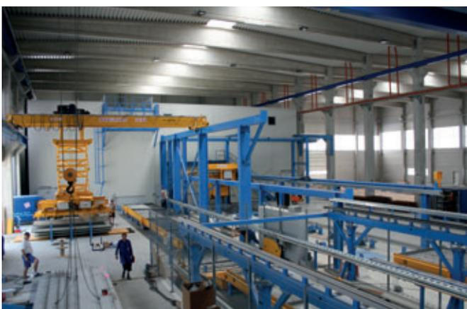
Blick auf den Entschalbereich und die dahinter liegende Trockenkammer. Parallel zur Entschalstation befindet sich die Betonierstation, von der aus die Formenpaletten in das Trockenlager gefahren werden.
