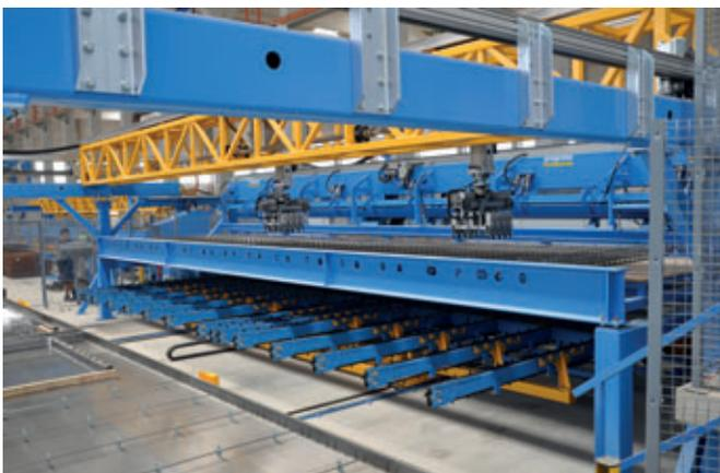
Der Mehrachsenroboter verlegt die Gitterträger und Längsbewehrung aus den zentralen Magazinen. Während die Richtmaschine die Längsstäbe produziert und auf einem Kettenmagazin ablegt, befördert das darunterliegende Gitterträgermagazin die frisch produzierten Gitterträger in Richtung Palette.
