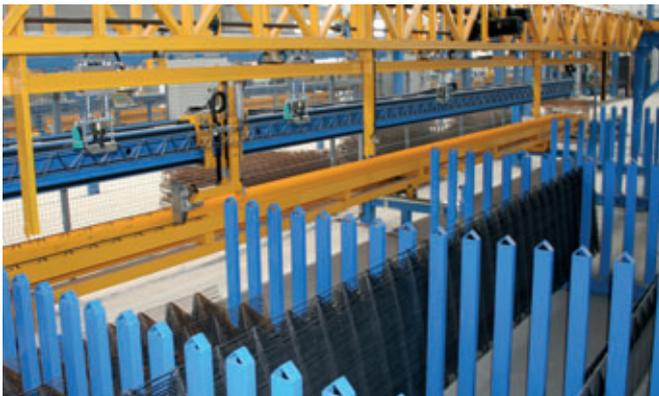
Die produzierten Gitterträger werden entweder im Magazin zwischengelagert oder direkt der Produktion zugeführt.
