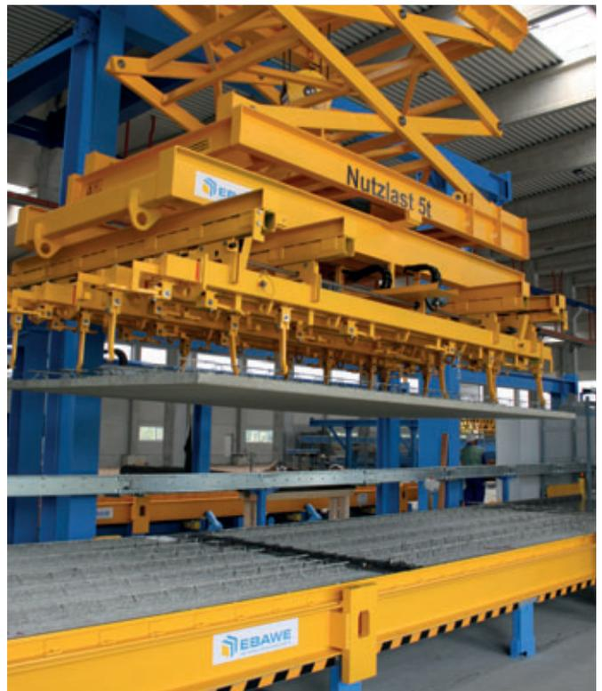
Mit der speziellen Abhebetraverse werden die Elementdecken direkt an den Gitterträgern von der Palette gehoben.
