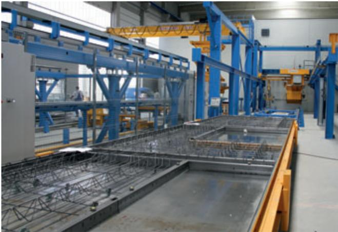
Fertig bewehrte Formenpalette auf dem Weg zur Betonierstation
