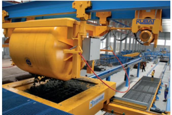
Die Kübelbahn von Kúbat bei der Betonübergabe an den Betonverteiler von Ebawe
