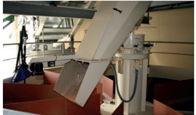
Die Gesteinskörnungen werden mit dem drehbaren Verteiler in das entsprechende Silo eingelassen. Bei den größeren Durchmessern sorgen eingebaute Falltreppen für eine materialschonende Befüllung.
