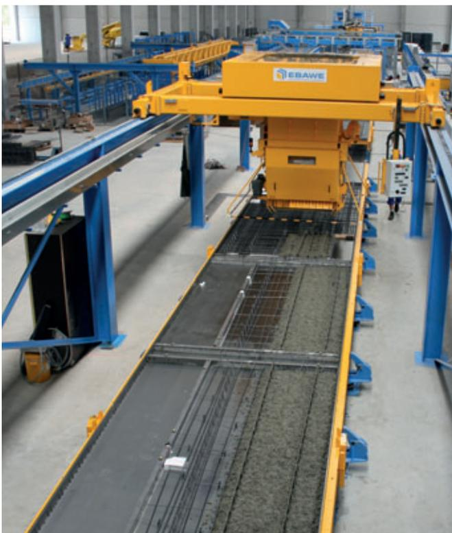
Der automatische Betonverteiler von Ebawe betoniert die fertig bewehrte Palette exakt entsprechend der Elementgeometrien.
