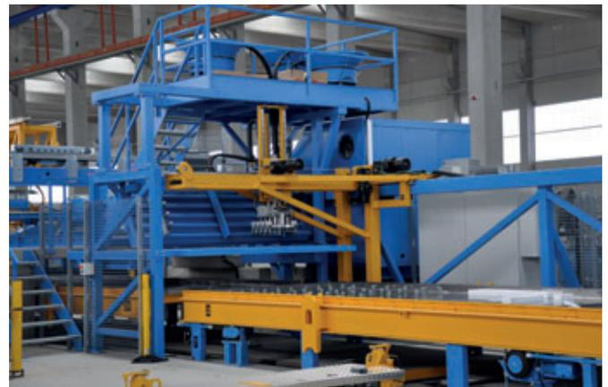
Zur Bewehrung hat sich Progress eine besondere Lösung ausgedacht: die Station beinhaltet zwei Richtmaschinen zur Längs- und Querstabproduktion, die entsprechende Abstandhalterautomatik sowie zwei Roboter zur exakten Verlegung von Stäben und Gitterträgern.
