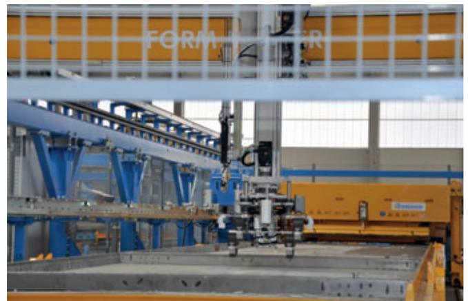
Schalungsroboter als Spezialausführung für den gleichzeitigen Transport von 2 Schalungen, mit Plotter, Reinigungs- und Trennmittelsprühstation. Hier werden die Schalungen durch den Roboter abgenommen, über eine Förderbahn gereinigt und zum Schalungslager transportiert.
